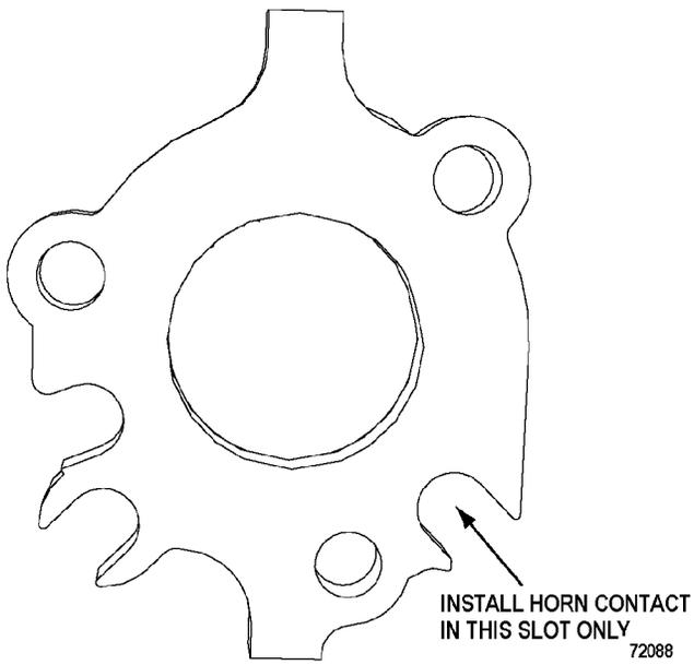
FIGURE 5-5. INSTALLATION LOCATION
